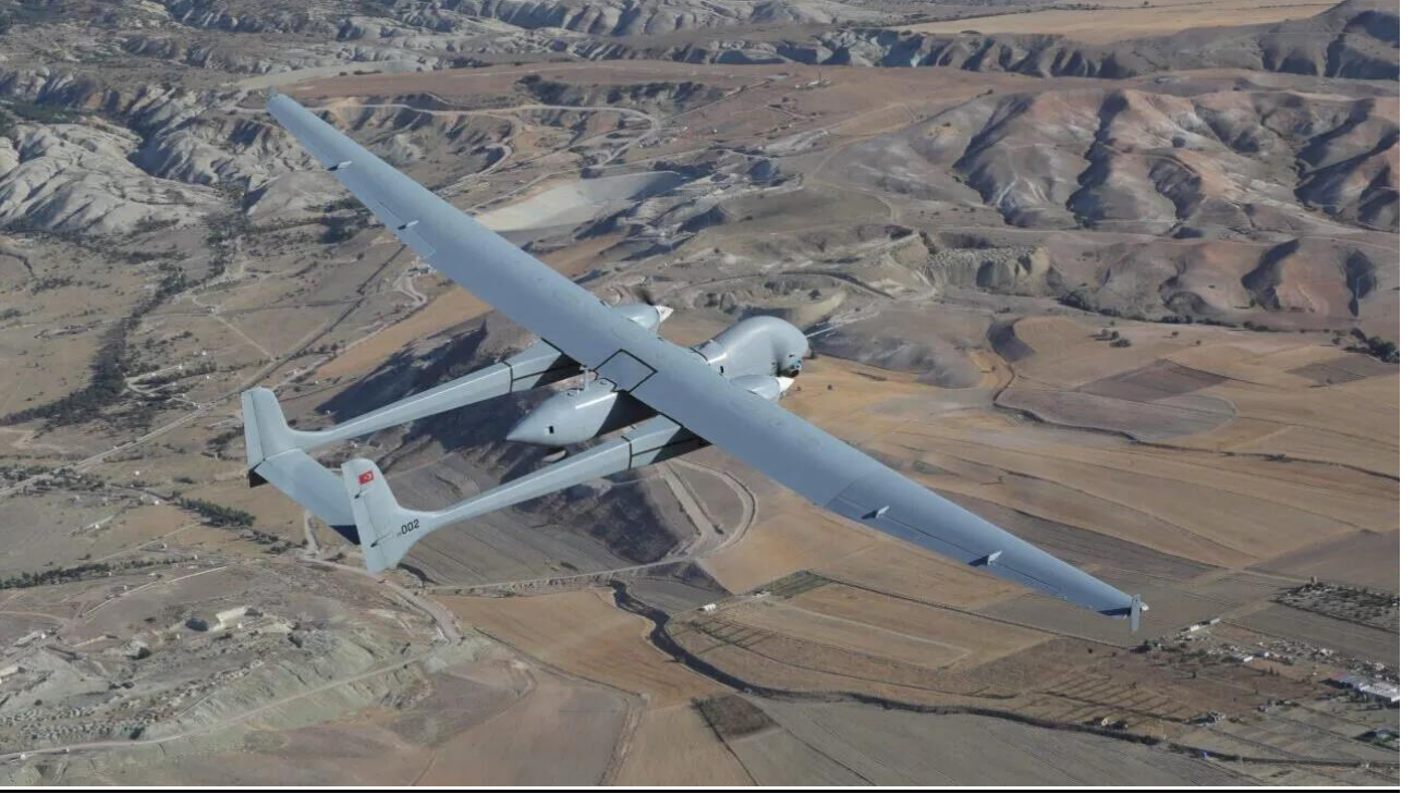
Şekil 6. Deprem sırasında baz istasyonu olarak görev yapan İHA
