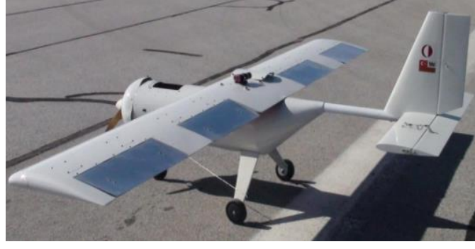
Şekil 4: TÜBİTAK 107M103 Projesi Kapsamında Tasarlanan Şekil Değiştirebilen İnsansız Hava Aracı [Seber G., 2016]
