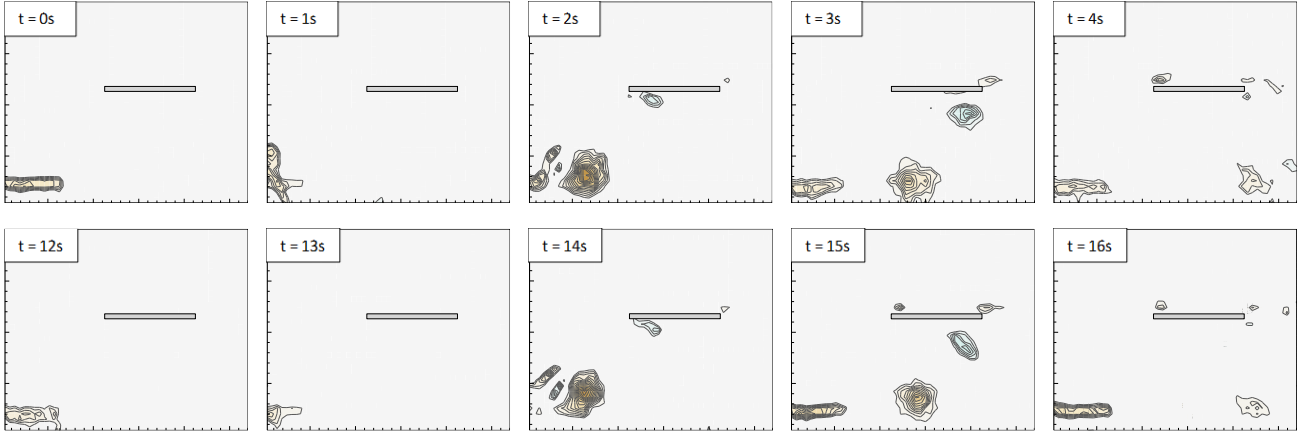
Şekil 18: h/c = -0.75 , T(1/2 \text{ tur}) = 3s için 12.saniyede ( t_2 durumu) ikinci sağanak üretiminin başlamasıyla kanat girdap etkileşimi
