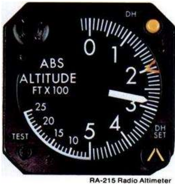
Şekil:2 Radyo altimetre kokpit göstergesi analog ve dijital görünümü
