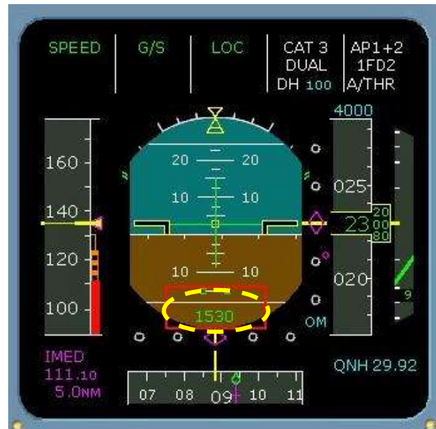
Şekil:2 Radyo altimetre kokpit göstergesi analog ve dijital görünümü
