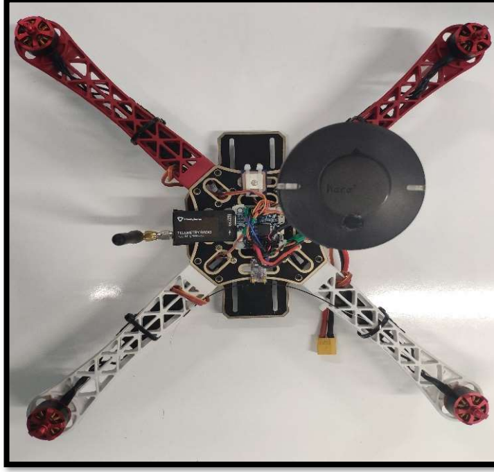
Şekil 11: Omnibus F4 V3S entegre F450 insansız hava aracı.
