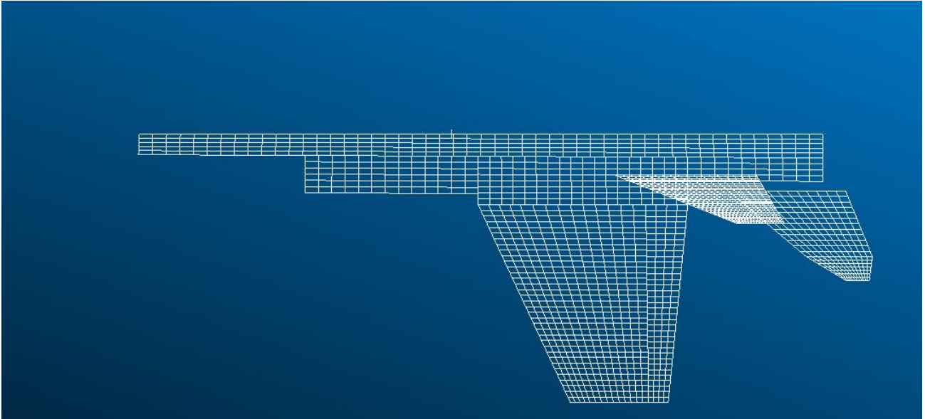
Şekil 4: İki Boyutlu Aerodinamik Yarım Model
