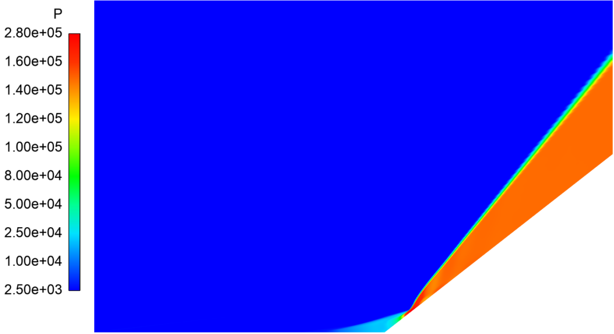
Şekil 13 İki boyutlu rampa için denek taşı problemi RT türbülans modeli eşdeğer basınç yüzeyleri
