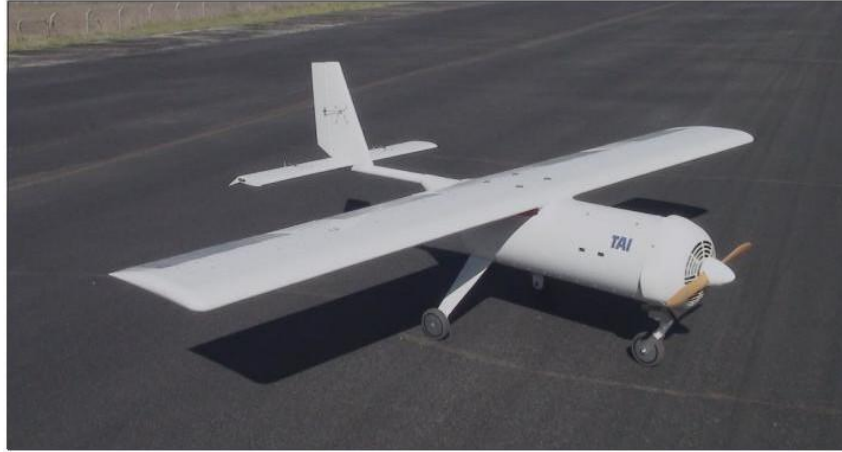
Şekil 7. TUSAŞ-ODTÜ İşbirliğiyle Tasarlanan Göreve Uyumlu Kanatlara Sahip İnsansız Hava Aracı [Ünlüsoy,2011]
