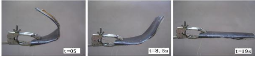
Şekil 4. Belirli Zaman Aralıklarında ŞHP Kompozit Dış Yüzey’de Meydana Gelen Şekil Değişimi [Sun,2016]
