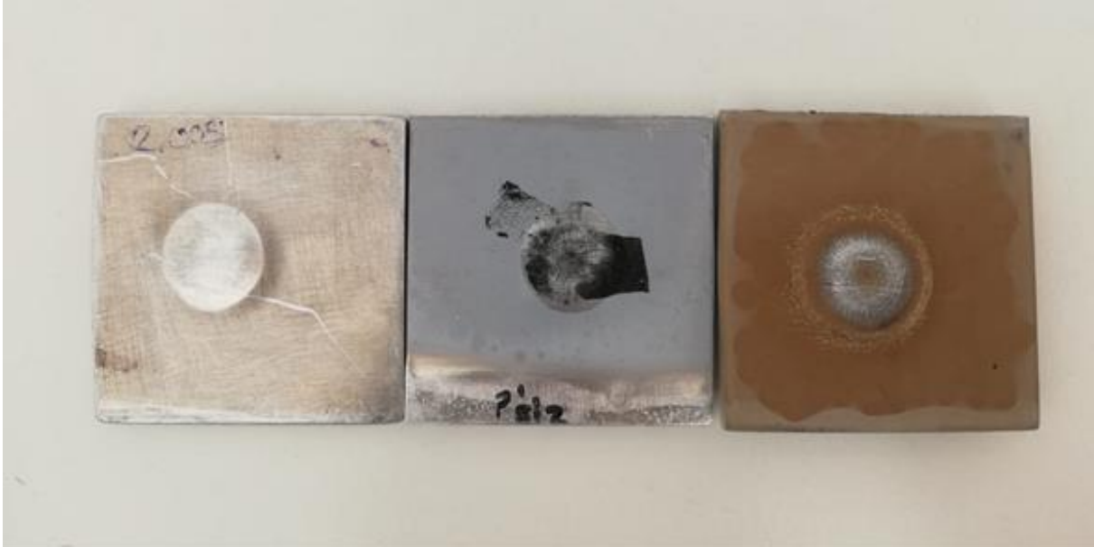
Şekil 25: Ön plaka üzerlerindeki deformasyonlar (soldan sağa): Yüzeyine herhangi bir işlem uygulanmamış AL6061-T6, yüzeyinde nanogözenekli alümina büyütülmüş ve polimer emdirilmemiş AL 6061-T6, yüzeyinde nanogözenekli alümina büyütülmüş ve polimer emdirilmiş AL 6061-T6
