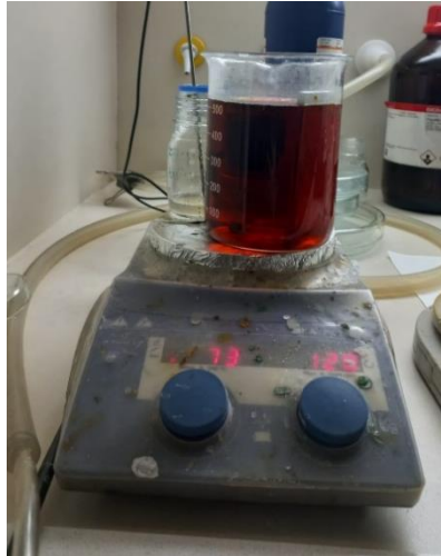
Şekil 7: Numunelerin kromik asitte bekletilmesi
