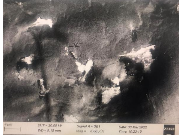
Şekil 16: Polimer emdirilmiş numunenin 4 mikron ölçeğinde SEM görüntüsü
