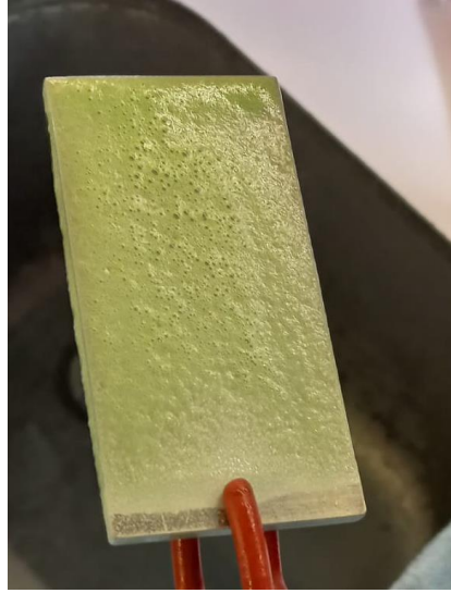
Şekil 5: Elektrokimyasal cilalamadan sonra numune görünümü
