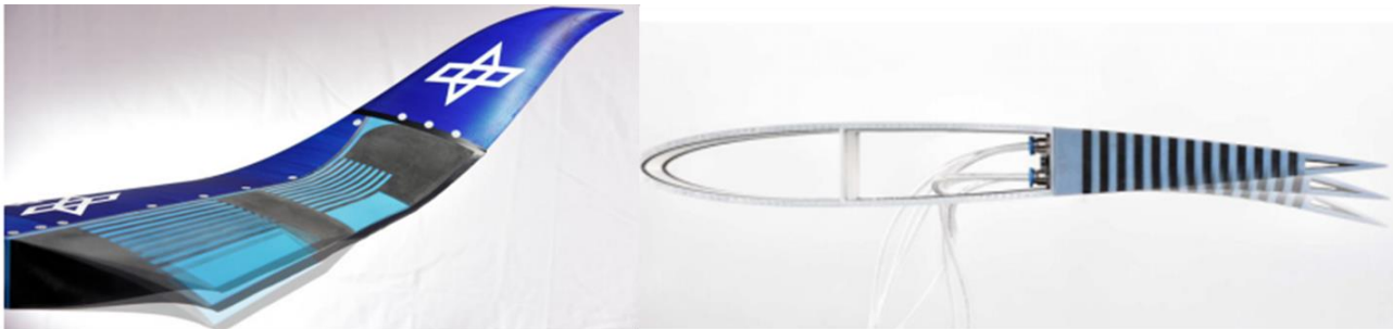
Şekil 1: Hücre yapısı kullanılarak tasarlanan bir kanat yapısı [Vasista vd., 2018]
