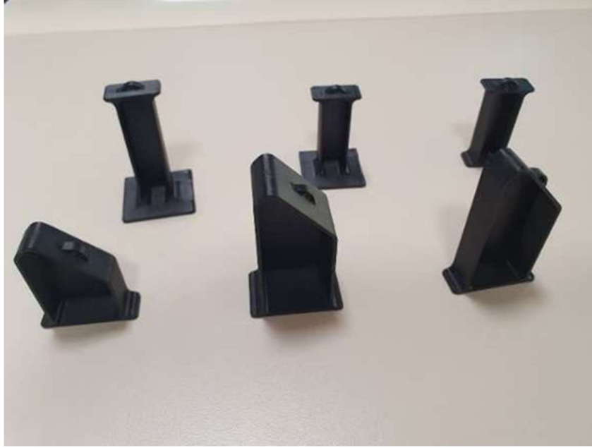
Şekil 7. PEKK ESD malzemeden üretilmiş kablaj destek braketleri
