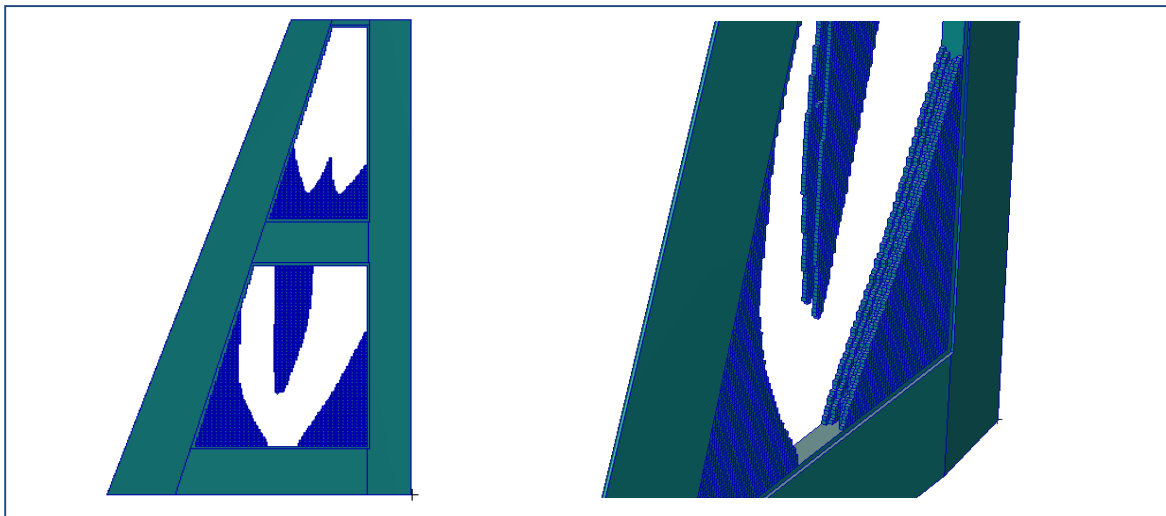
Şekil 11 (a) ve (b) : (a) 8 mm r_{min} ile 150. İterasyon yapısı (b) alt kanat detayı
