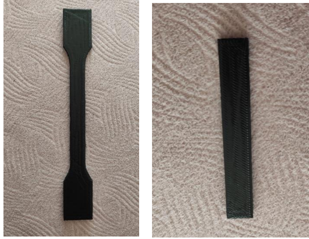
Şekil 5: Çekme testi numunesi (sol), üç nokta eğme testi numunesi (sağ)
