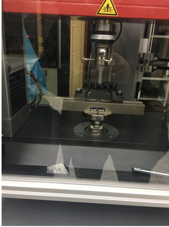
Şekil 2.3.4: Üç Nokta Eğme Deneye Ait Yükleme Koşulları
