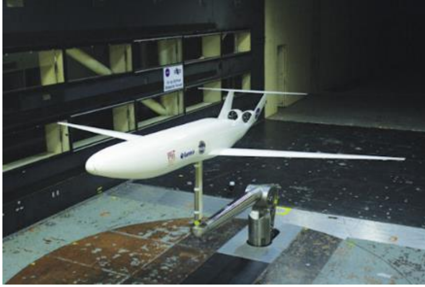
Şekil 8: Aurora Firması'nın FDM yöntemi ile Ürettiği 1:11 Ölçekli Rüzgar Tüneli Test Modeli [Aurora Flight Sciences, 2022]
