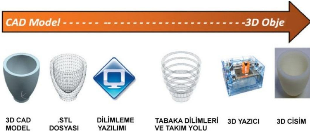
Şekil 1: Eklemeli İmalatın Proses Akışı [Campbell, 2015]
