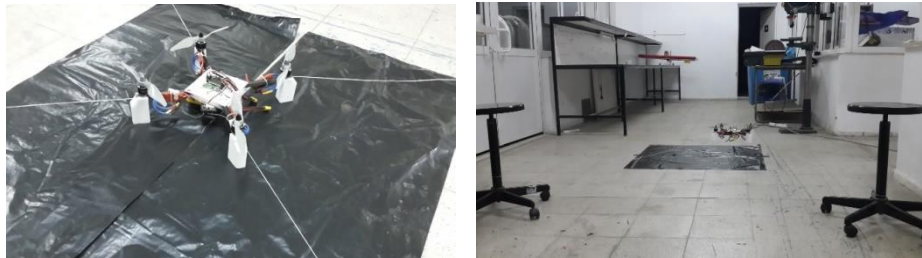
Şekil 9: Quadrotoru ipler ile bağlayarak zarar görmeden denge ayarlarının yapılması
