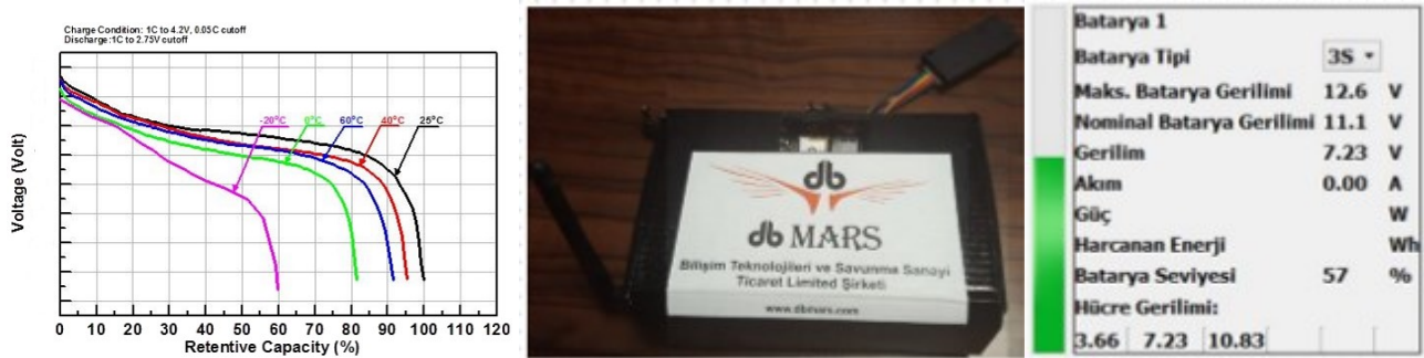
Şekil 7. Sıcaklık Değişimi ile Batarya Voltaj Seviyesini ve Kullanım Kapasitesini Gösteren Grafik [Savory,2015] ve DB MARS Batarya Yönetim Sistemi (BYS)
