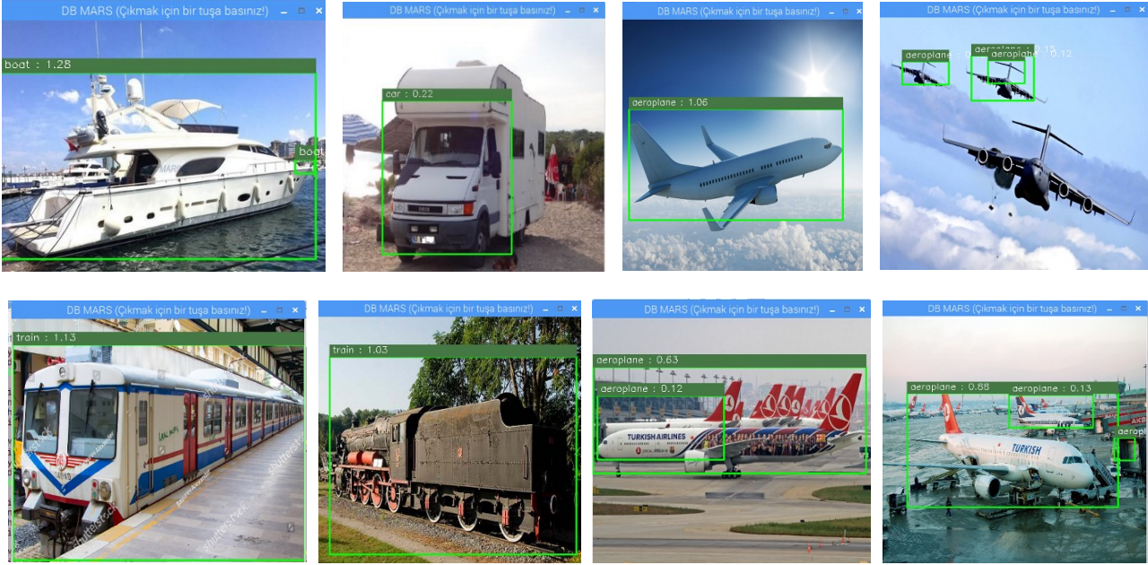
Şekil 5: Eğitim Setlerindeki Form veya Farklı Açısal Bilgi Eksikliğine ya da Çoklu Üst Üste Nesnelere Yönelik Hata Tespiti
