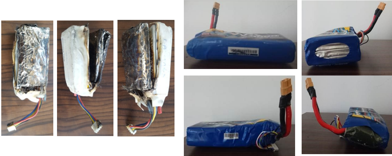
Şekil 6: Kırım Sonrası Li-Po Bataryalardaki Yapısal Bozulmalar
