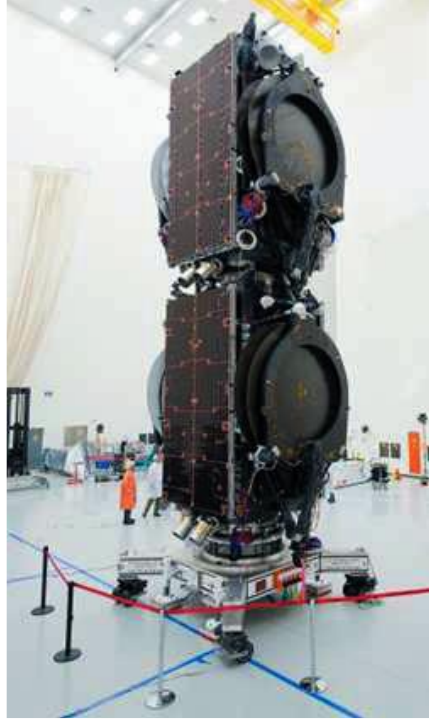
Şekil 1: EUTELSAT 115 West B Uyduları İkili Fırlatma Konfigürasyonu
