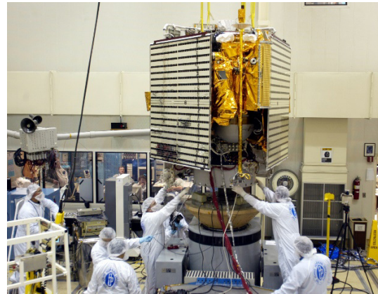
Şekil 1: Yatay ve düşey yönlerde uzay araçlarının titreşim testleri
