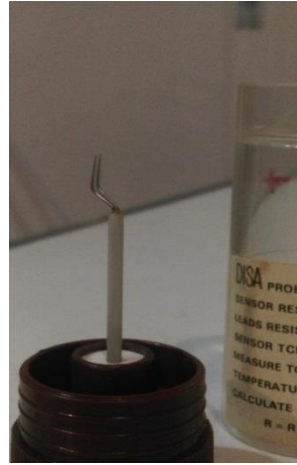
Şekil 8. Dantec Dynamics 55P15 tipi sınır tabaka probu
