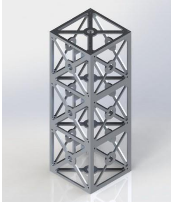
Şekil 1: 3 Birimlik Küp Uydu Yapısı
