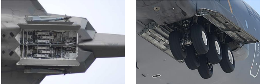
Şekil 1. Uçaklarda karşılaşılan tipik kavite örnekleri: Mühimmat haznesi (solda) ve iniş takımı (sağda)
