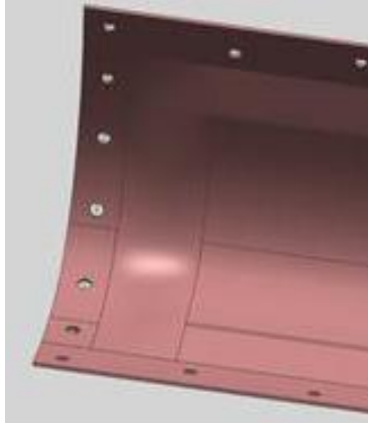
Şekil 10. Montaj Delikleri Açılmış İç Duvar
