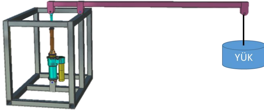
Şekil 12: Fonksiyonel Test Düzeneği – Çekme Yüğü
