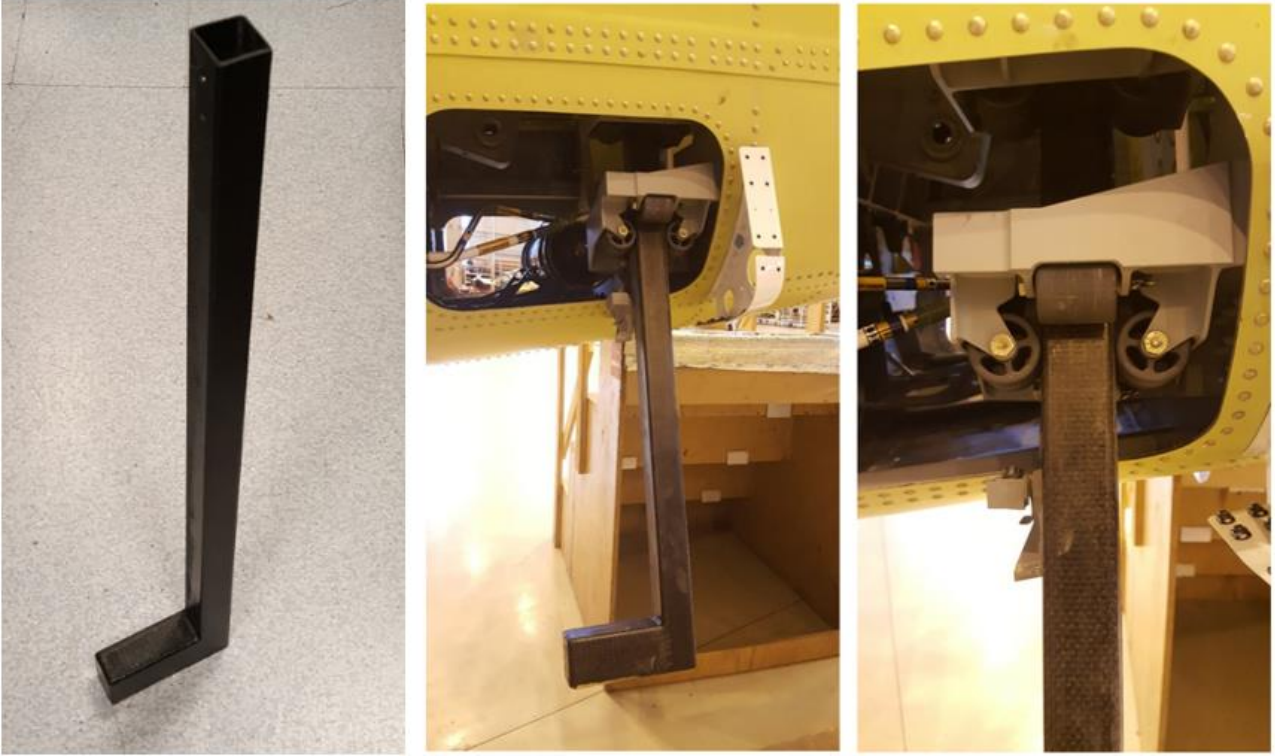
Şekil 6: Kompozit parça ve parçanın uçak üzerine takılması
