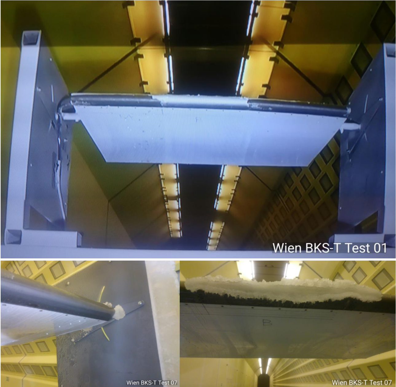
Şekil 15: Hata durumu: Orta panelin oluşan arıza nedeniyle görev yapamadığı durum
