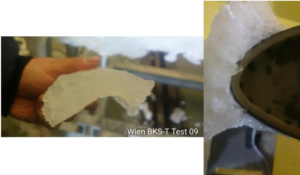
Şekil 17: -4 °C'de sistemin çalışmadığı durum
