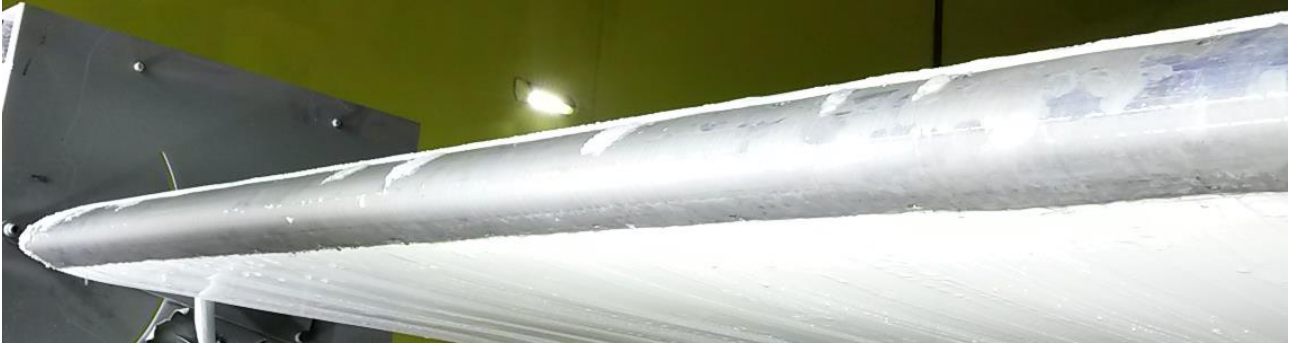
Şekil 12: -30 °C'de yapılan ilk test ve iyileştirme sonrası tekrarlanan testlerin örnek sonuçları
