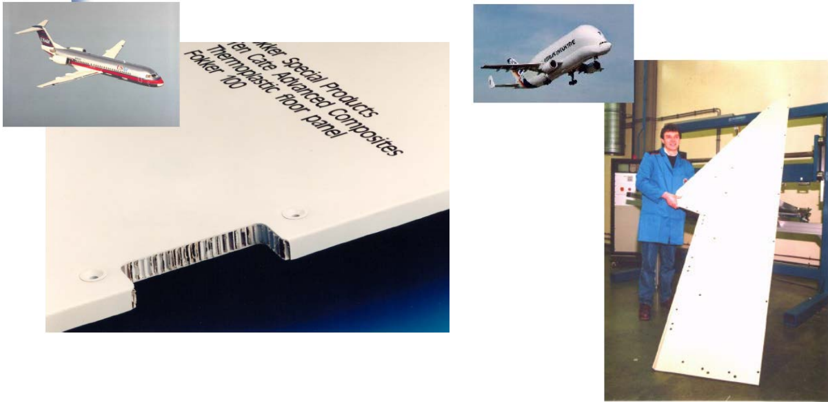
Şekil 6: Termofolding yöntemi ile üretilmiş Fokker 100 ve Airbus Beluga kargo uçakları taban panelleri [Offringa, 2014]
