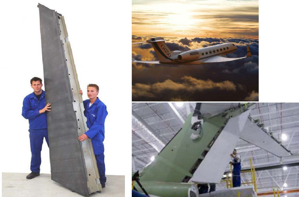
Şekil 5: G650 özel jet uçağının TP malzeme ile üretilmiş yön ve irtifa dümeni parçaları [Offringa, 2014]
