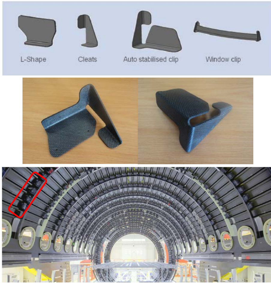
Şekil 2: A350XWB yolcu uçağı gövde klipleri
