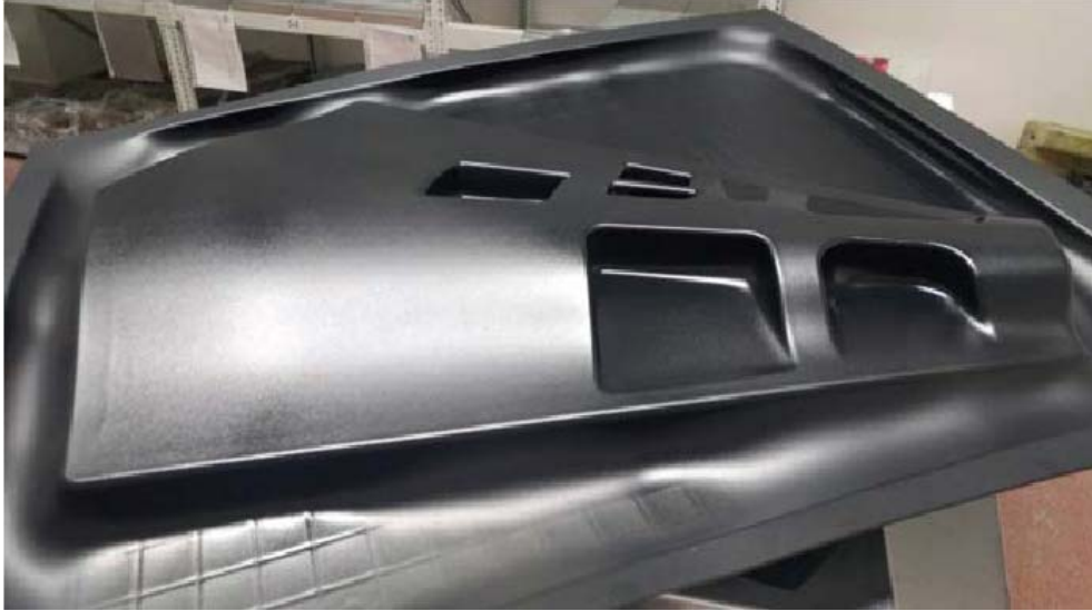
Şekil 4: Kalıptan çıkartılmış termoplastik parça
