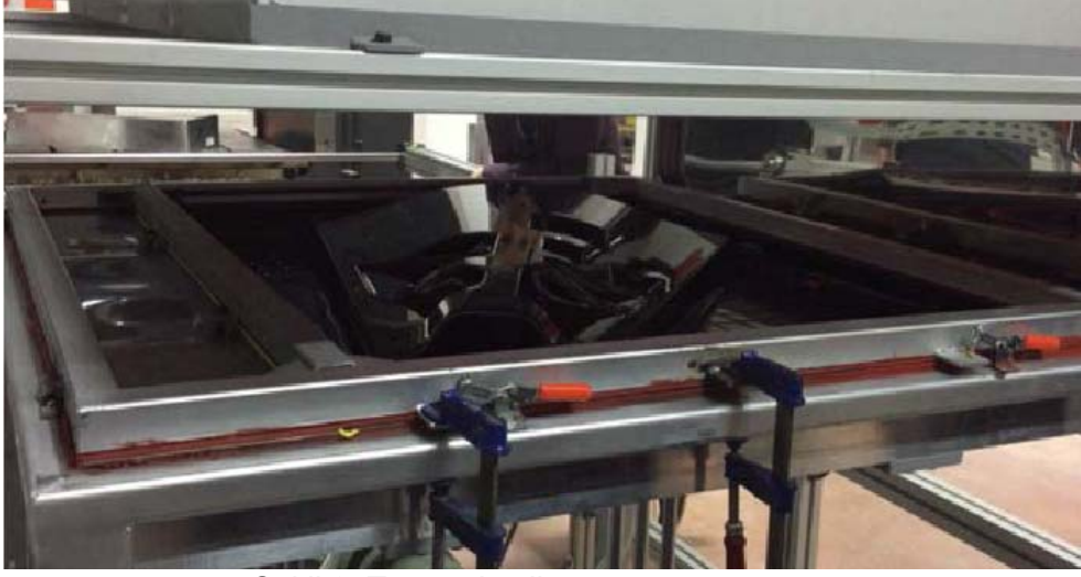
Şekil 3: Termoplastik parçanın soğuması
