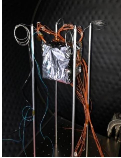
Şekil 6: Test kutusunun ısıl vakum çemberi içindeki yerleşimi
