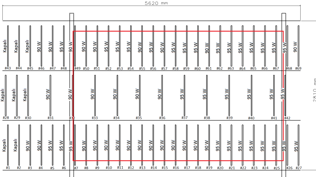
Şekil 12 : Güney görev yükü sıcak durum testi gerçekleştirilirken TVC içerisindeki ısıtıcılara verilecek güç değerleri
