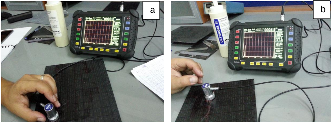
Şekil 4: Kompozit plakaların ultrasonik muayene örnekleri
