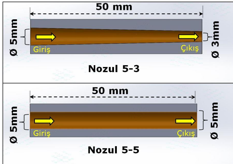
Şekil 2: Nozul geometrileri ve ölçüleri
