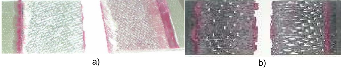
Şekil 6: Tek taraflı bindirmeli bağlantıların a) cam-cam ve b) karbon-karbon elyaf takviyeli kompozit malzemelerin yorulma hasarı
