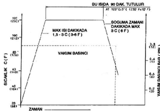
Şekil 3: Karbon prepreg malzemeye ait vakum basıncı- ısı-zaman grafiği
