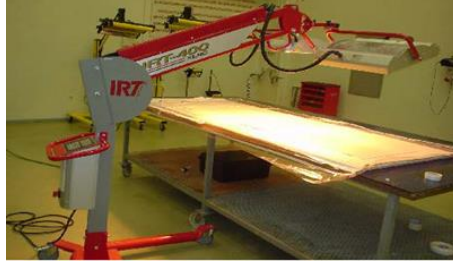
Şekil 4: Cam elyaf takviyeli kompozit malzemelerin kür işlemi
