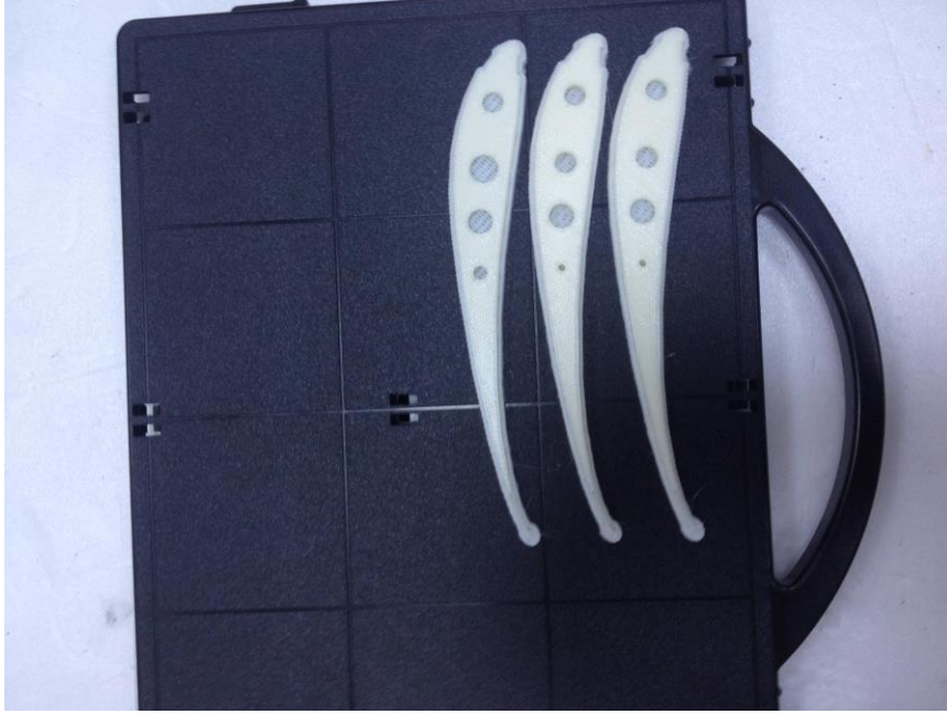
Şekil 7: 3B Baskı ile Üretilen Kanat Ribleri
