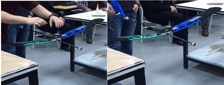
Şekil 15: Kanat Yükleme Testleri
