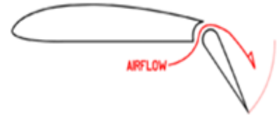
Şekil 3: NACA 64 2 -415 profilinin aerodinamik ve geometrik karakteristiği ve slotlu flap kesiti.
