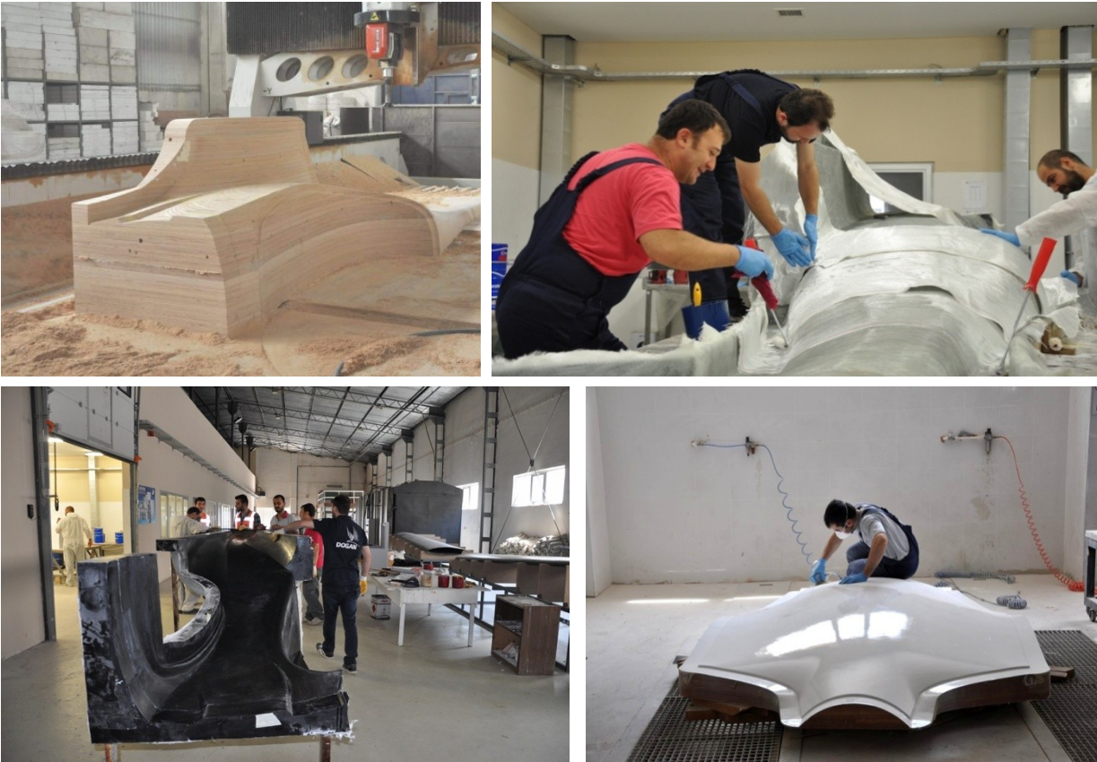
Şekil 11: DOĞAN'ın gövde model ve kalıplarının üretim çalışmaları.
