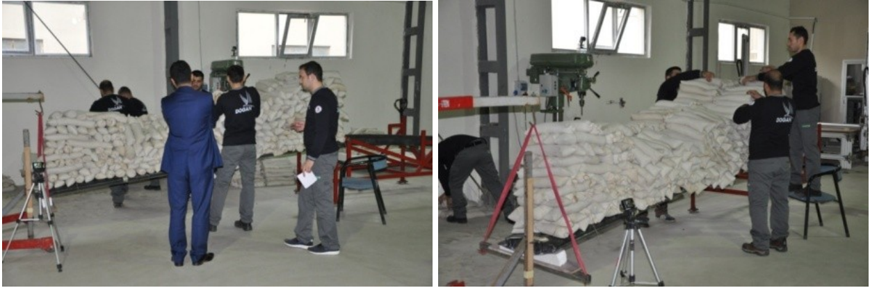
Şekil 12: DOĞAN'ın kanat statik yükleme testi.
