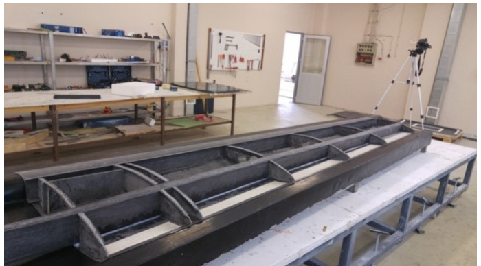
Şekil 10: DOĞAN'ın kanat kalıp ve parça üretim fotoğrafları.
