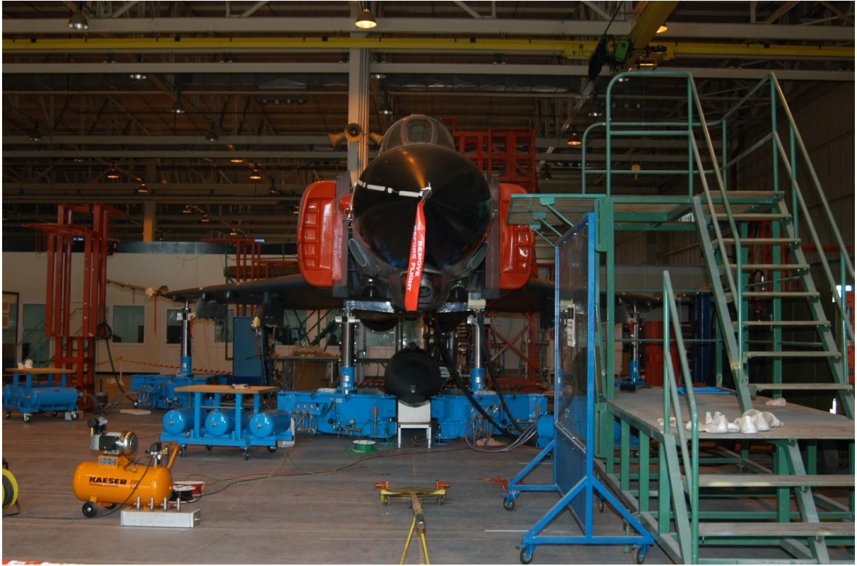
Şekil 3: Yer Titreşim Testleri için Süspansiyon Sistemi Kullanımı
