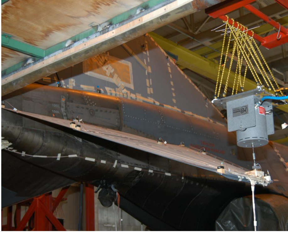
Şekil 13: Örnek Sensör Montajı ve Kablolaması
