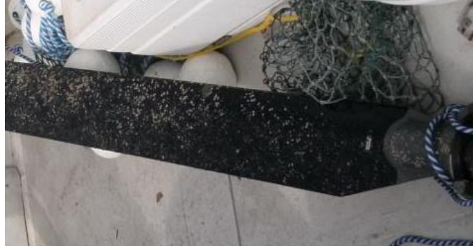
Şekil 1: Helikopter Palinde Çevresel Taş Hasarı
