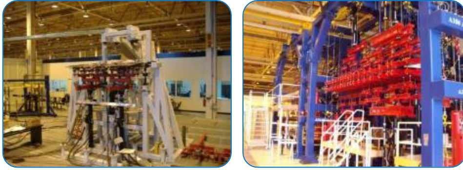
Resim 5: "TUSAŞ, A400M / A350" Aileron, Spoiler Sertifikasyon Testleri 2008-2013
