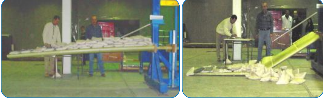
Resim 4: "TUSAŞ, UAV" Kanat Statik Testi (2001)
