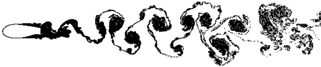
Şekil 7: FB3500-1750 Profili Etrafındaki Akış Alanı – Re = 50 000
