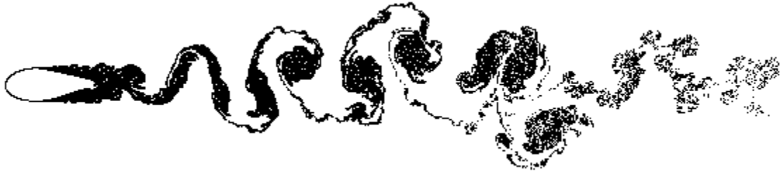
Şekil 6: FB3500-0875 Profili Etrafındaki Akış Alanı – Re = 50 000
