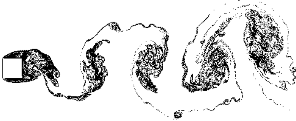
Şekil 2: Kare Etrafındaki Akış Alanı – Re = 20 000
