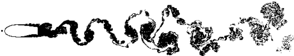
Şekil 8: FB3500-2250 Profili Etrafındaki Akış Alanı – Re = 50 000
