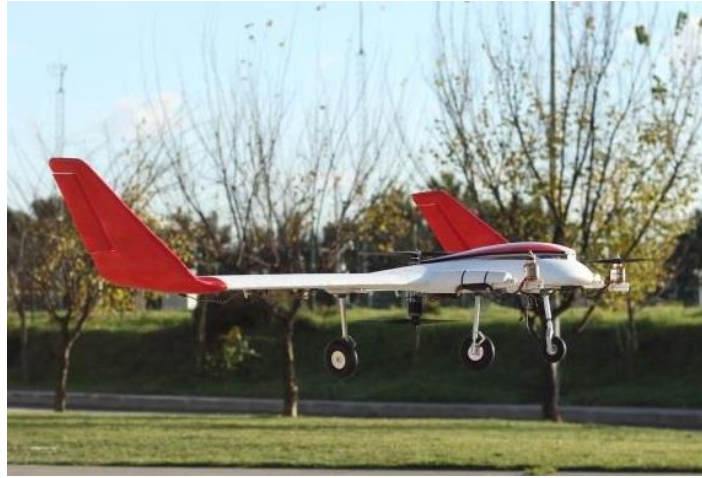
Şekil 3: Prototipin askı uçuş testi.
