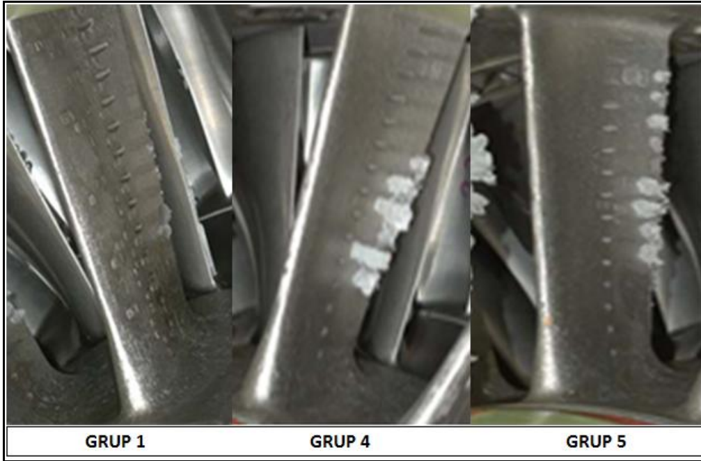
Şekil 4: Motor buzlanma test sonuçları
