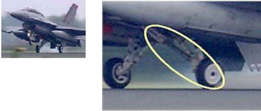
Şekil 1: MMK'dan yapılmış iniş takımı destek dikmesi [Montanari 2009]
