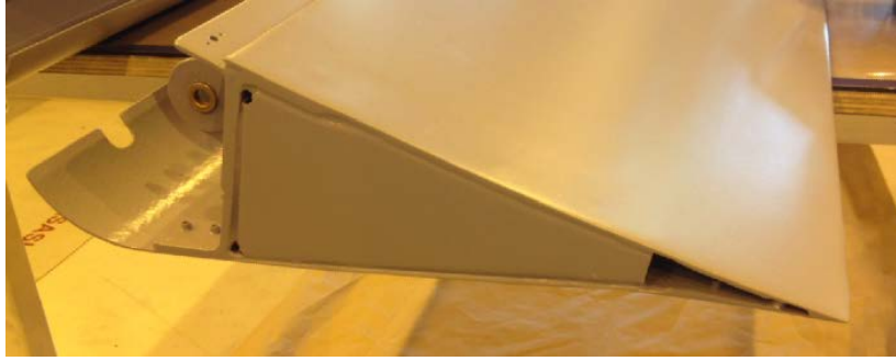
Şekil 13: Kontrol Yüzeyi Montajı
