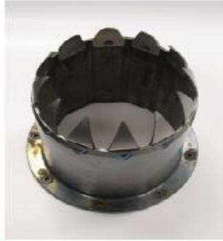
Şekil 3: Dişli Yakınsak-İraksak Lüle.[Henderson, Bridges, 2010]
