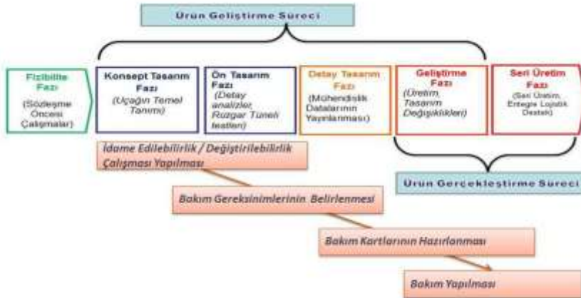
Şekil 1: Uçak Üretimi/Modernizasyonu Aşamalarındaki Bakım Statüsü
