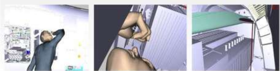
Şekil 3: Bakım personelinin, bir ekipmanın üzerindeki sigortaları herhangi bir çakışma yaşanmadan ayna ile kontrol etmesi.
