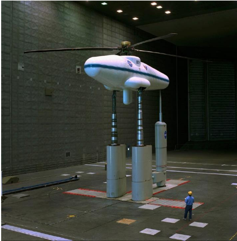
Şekil 2: UH-60A Tam Ölçekli Rotor - Rüzgâr Tüneli Test İcrasından Bir Görüntü
