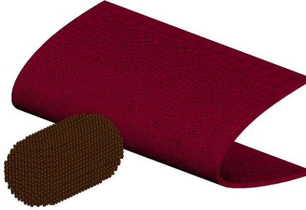
Resim 1: Uçak kanadı kabuk yapısı çözüm ağı görünüşü
