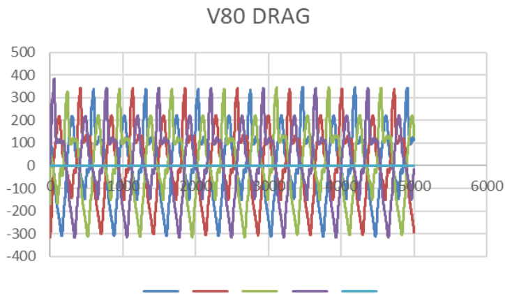
Şekil 16 80m/s hızda modelin ürettiği sürüklenme kuvvetlerinin zamana bağlı grafiği
