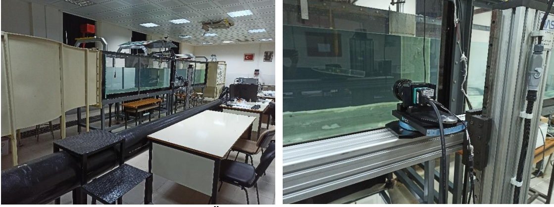
Şekil 3. Osmaniye Korkut Ata Üniversitesi su kanalı ve PIV sistemi görseli [Erdem, 2022]
