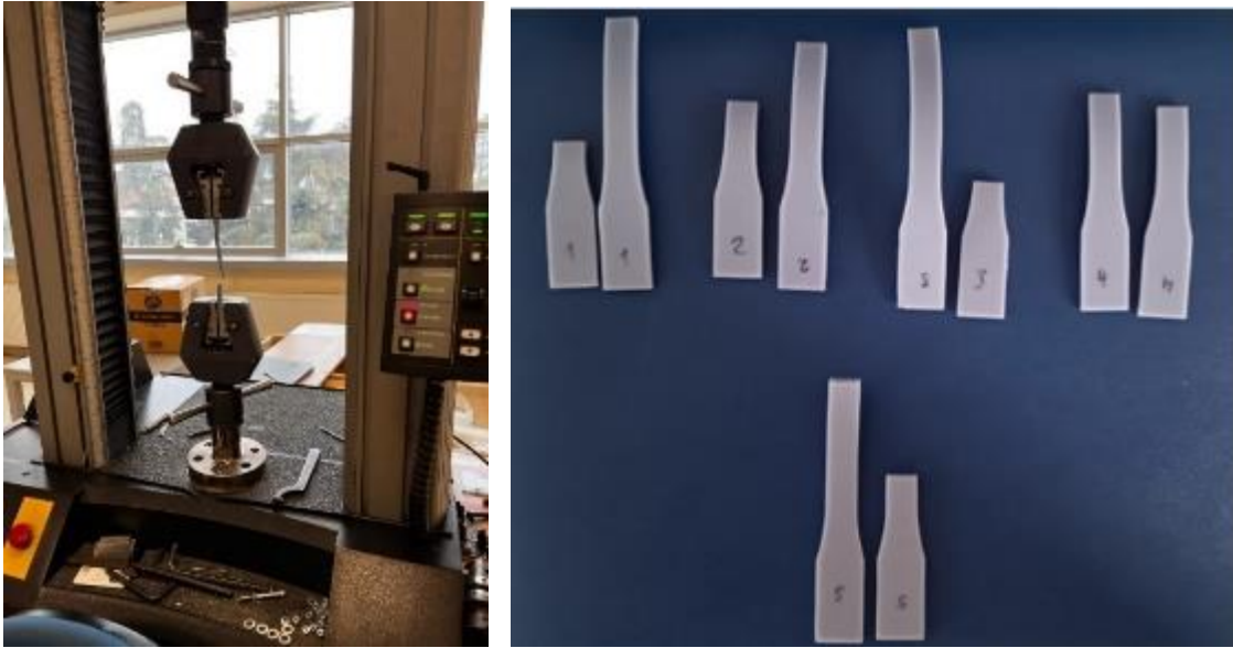
Şekil-5: Çekme testi ve kopan numuneler
