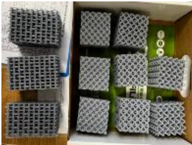
Şekil-12: Üretilen 2mm kiriş kalınlığına sahip 5×5×5 numuneler.
